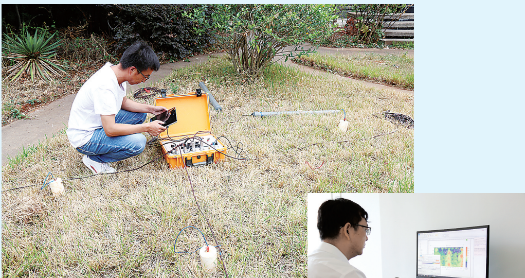
▲图为技术人员正在利用MT大地电磁仪进行探测作业。 ▶图为技术人员在后台对采集的数据进行分析处理。 施建忠 摄
