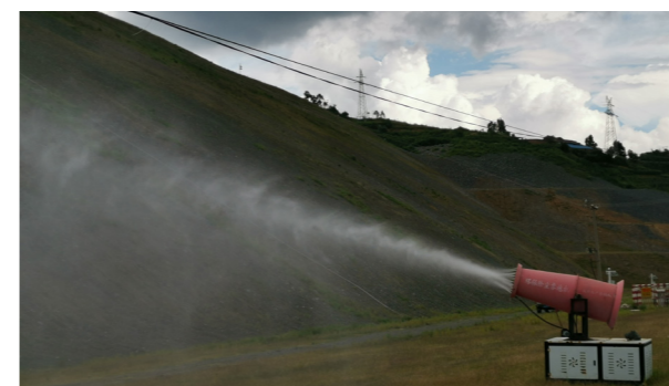
凉山矿业采矿厂采用环保雾炮喷洒降尘
